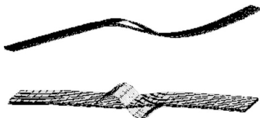
图 4 分层损伤层合板上、下子板分离和嵌入振型
